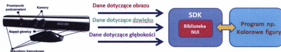
Rys. 1. Współpraca sensora Microsoft Kinect z własną aplikacją.
