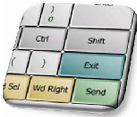
Ryc. 6.7. Urządzenie Neuro Key z zestawu Emotiv 1/2 – klawiatura obsługiwana za pomocą fal mózgowych
