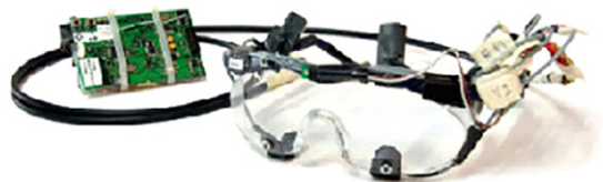
Ryc. 5.3. Przykładowy eye-tracker mobilny w formie zakładanego na głowę, niewielkiego urządzenia umożliwiającego swobodne ruchy podczas badania
