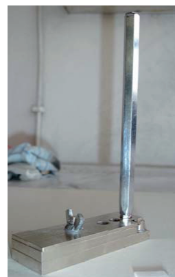
Rys. 7. Foremka złożona do przygotowania próbek popiołu lotnego
