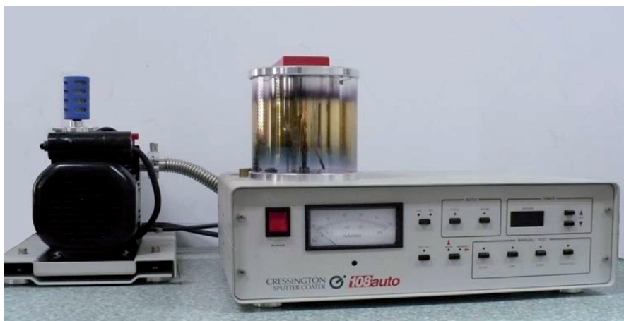
Rys. 4. Napyłarka Cressigton 108 auto
