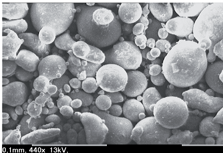
Rys. 6. Mikrostruktura skaningowa proszków metalicznych – powiększenie 440x
