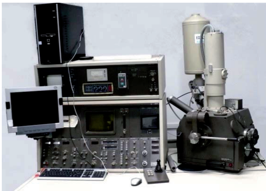
Rys. 1. Mikroskop elektronowy Philips 525M znajdujący się w Instytucie Techniki UP
