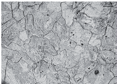
Rys. 3. Przykłady mikrostruktury staliwa L20HM austenitzowanego w temperaturze 920°C, z ujawnionymi granicami ziarn byłego austenitu
