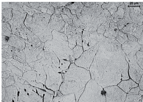
Rys. 3. Przykłady mikrostruktury staliwa L20HM austenitzowanego w temperaturze 920°C, z ujawnionymi granicami ziarn byłego austenitu
