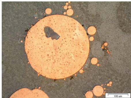
Rys. 9. Stop \text{Fe}_{60}\text{Cu}_{20}\text{P}_{10}\text{Si}_5\text{B}_5 . Struktura fraktalna złożona ze sferoidalnych obszarów bogatych w miedź w osnowie eutektycznej Fe-P-Si-B
