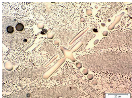
Rys. 10. Stop \text{Ni}_{78}\text{Ag}_2\text{P}_{20} . Wytrawione na ciemno sferulityczne obszary krystalicznego srebra w osnowie złożonej z eutektyki \text{Ni}/\text{Ni}_3\text{P} oraz dendrytów bogatych w nikiel
