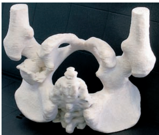
Rys. 4. Model anatomiczny miednicy wykonany techniką 3DP [3]
