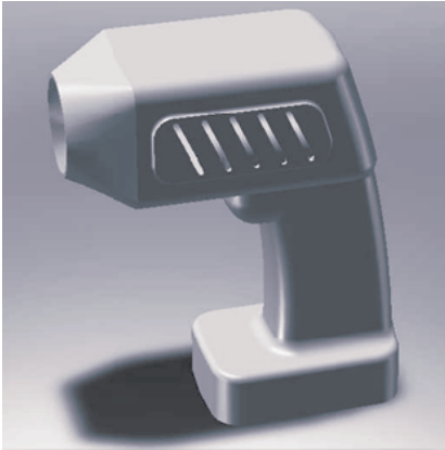
Rys. 1. Model obudowy wkrętarki wykonany za pomocą aplikacji SolidWorks
