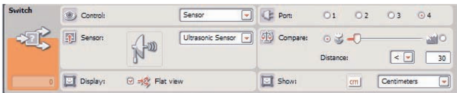
Rys. 6. Blok sensora ultradźwiękowego połączony z instrukcją warunkową
