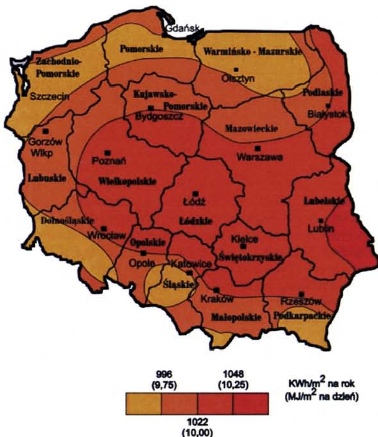
Rys. 3. Natężenie promieniowania słonecznego w Polsce (wg danych Instytutu Meteorologii i Gospodarki Wodnej) [8]
