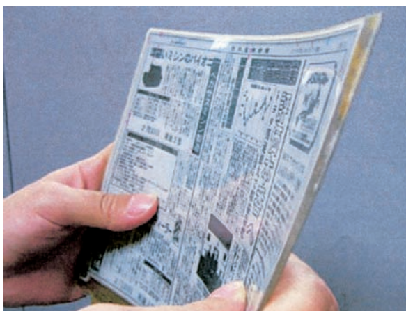
Rys. 16. Przykład 9,7' elastycznego czytnika wykonanego technologią EPLaR
