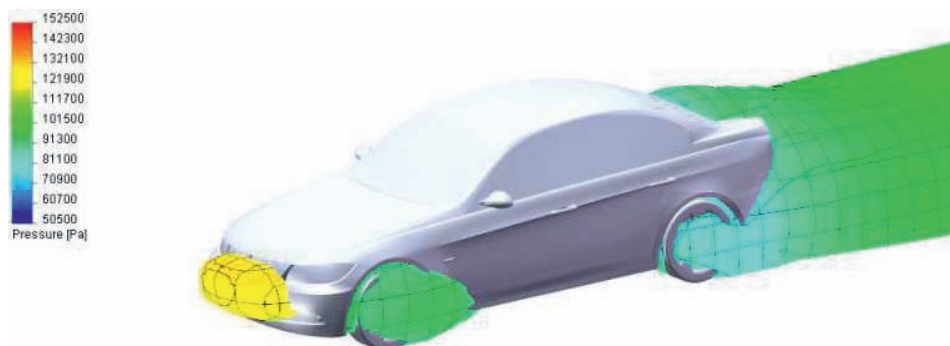
Rys. 6. Obszary ciśnienia, w których prędkość przepływu nie przekracza 15 m/s
