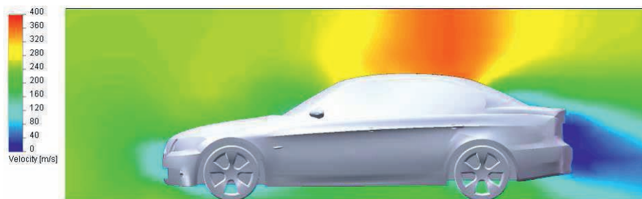
Rys. 3. Rozkład prędkości w płaszczyźnie symetrii
