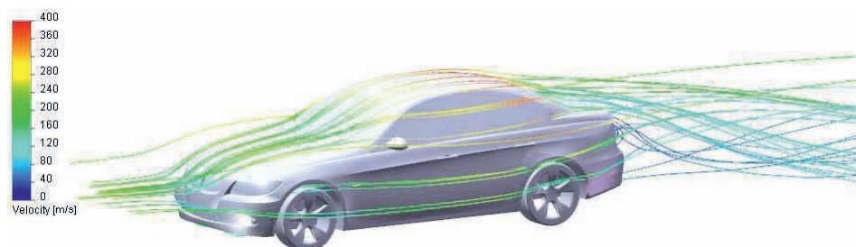
Rys. 9. Trajektorie powietrza podczas opływu karoserii
