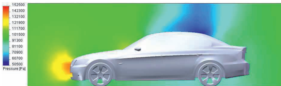
Rys. 2. Rozkład ciśnienia w płaszczyźnie symetrii
