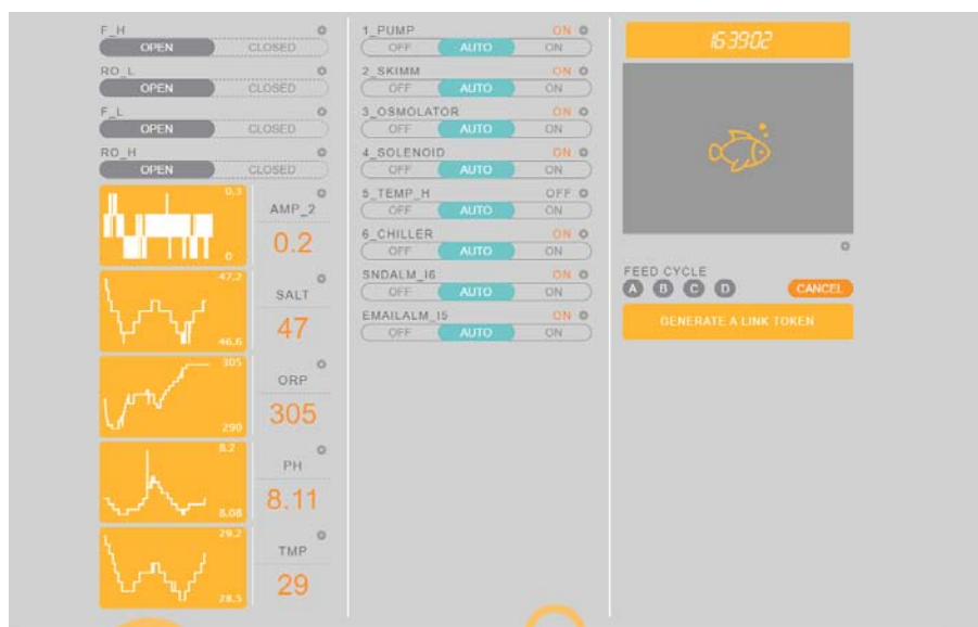
Obr. 16. Panel sledovaných veličin v mořském akváriu (vlevo číselně vyjádřená okamžitá spotřeba (amp), salinita (salt) oxidačně-redukční potenciál (ORP), hodnota pH (pH), teplota (TMP).
