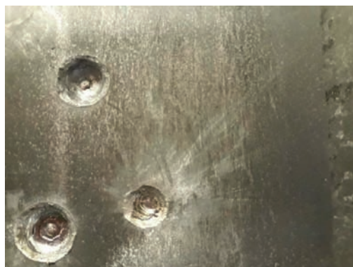
Rys. 10. Płytkę ze stali X153CrMoV12 stan dostawy z widocznymi miejscami trafień pocisków FMJ. U góry 7,62 x 39, na dole z lewej .30-06, z prawej .223 Rem.
