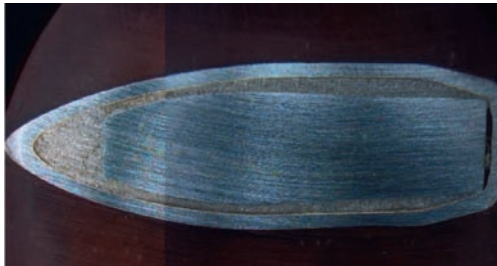
Rys. 8. Przekrój pocisku FMJ 7,62 x 39 z widocznym stalowym rdzeniem
