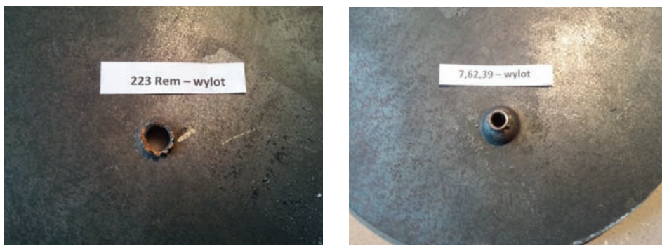
Rys. 20. Porównanie otworów wylotowych w stali S235JR
