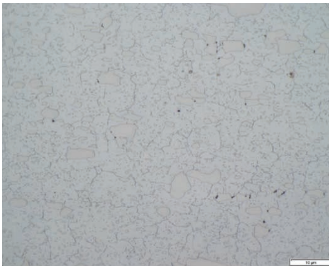
Rys. 4. Mikrostruktura stali X153CrMoV12 stan po hartowaniu, mik. świetlny, pow. 1000
