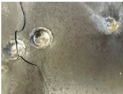
Rys. 11. Płytkę ze stali X153CrMoV12 stan zmiękczoney z widocznymi miejscami trafień pocisków FMJ. Od lewej 7,62 x 39, .30-06 oraz .223 Rem.
