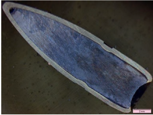
Rys. 7. Przekrój pocisku FMJ .223 Rem
