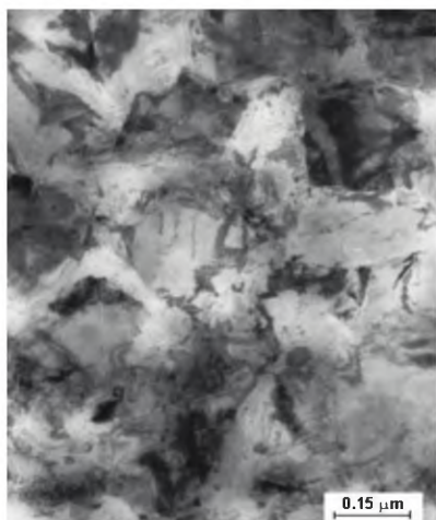
Rys. 3. Mikrostruktura spieku otrzymanego z diamentu oraz 5% masy Ti [1].
