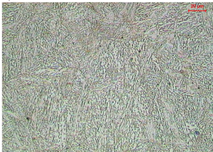
Rys. 2. Mikrostruktura próbki po cyklach cieplnych 1000^{\circ}\text{C}/800^{\circ}\text{C} , t_{8/5} = 13 \text{ s} ; a) mikroskop świetlny, b) mikroskop skaningowy
