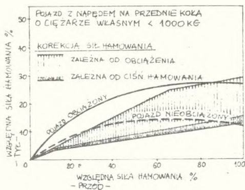
Rys. 10. Diagram rozkładu sił hamowania kół przednich i tylnych w pojeździe z ABS 2-kanalowym
