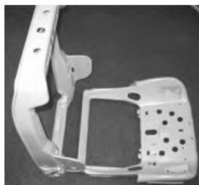
Rys. 4. Odlewane podzespoły wnętrza samochodów osobowych ze stopów Mg: a) obudowa kolumny kierownicy, b) szkielet siedzenia (Jaguar) [15]
