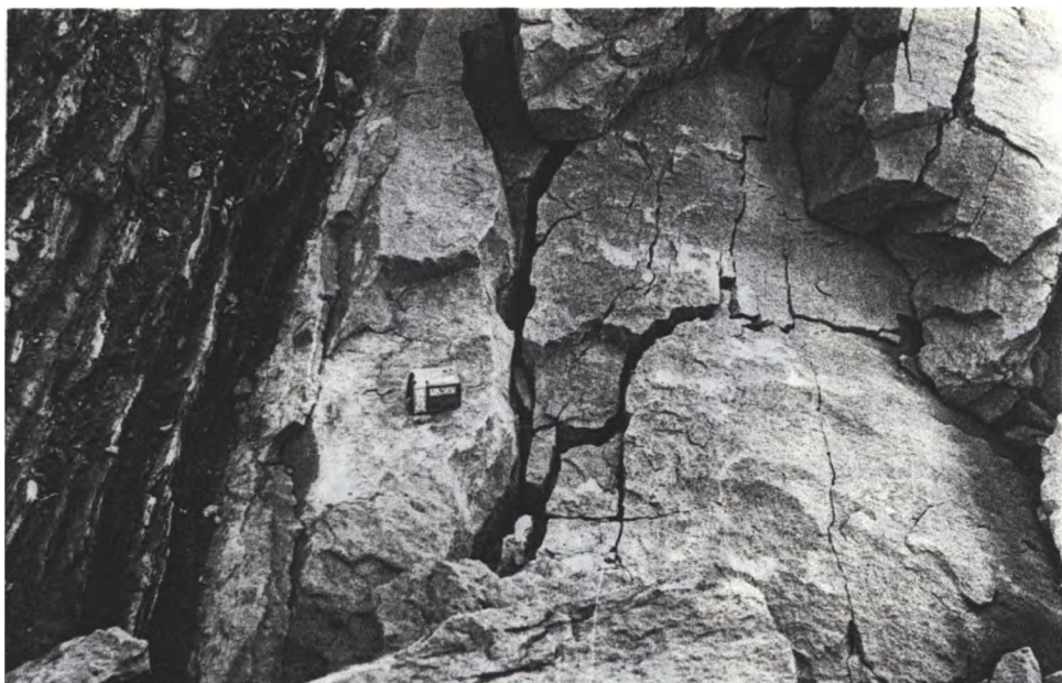
Fot. 6. Świeże szczeliny dochodzące do 8 cm szerokości w obrębie pakietów skalnych podciętych przez abrazję
