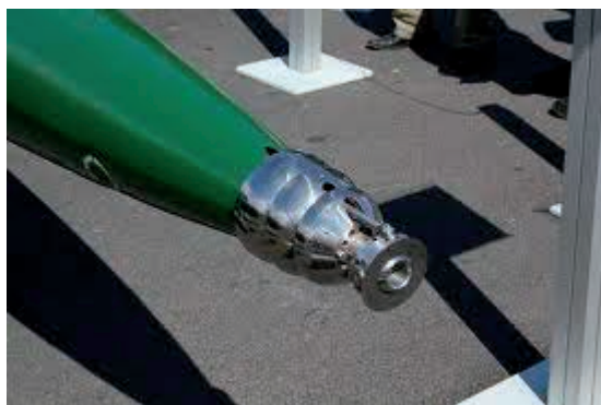
Rys. 2. Torpeda Szkwiał na targach zbrojeniowych z dobrze widocznym kawitatorem (www.world-affairsboard.com)
