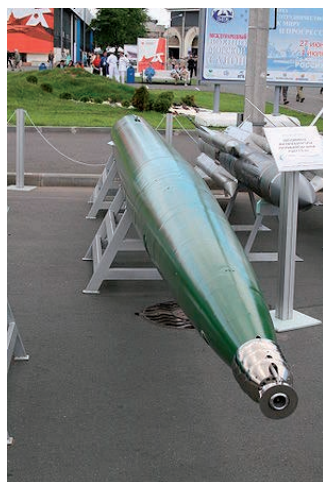
Rys. 2. Torpeda Szkwiał na targach zbrojeniowych z dobrze widocznym kawitatorem (www.world-affairsboard.com)
