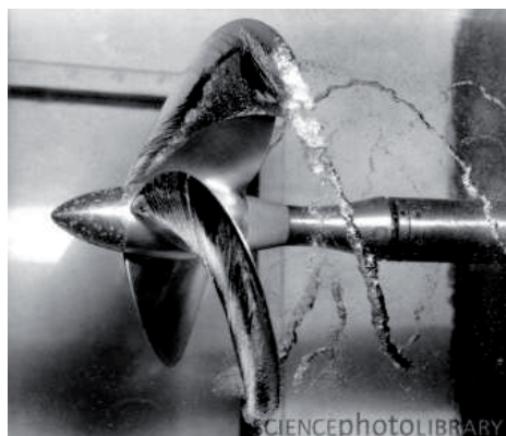
Rys. 1. Kawitacja na śrubie okrętowej (www.sciencephoto.com)
