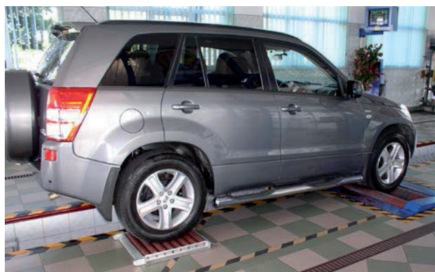
Rys. 3. Przykład badania siły hamowania w pojeździe z nierozłączalnym napędem wszystkich kół (pomocnicze – wolno stojące rolki podstawione pod tylną oś)
